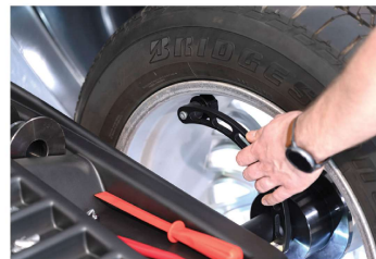
Электронная измерительная линейка (ЭИЛ) дает возможность автоматически определять координаты установки уравновешивающих грузов на внутренней поверхности дисков. Рукоятка ЭИЛ позволяет точно позиционировать и устанавливать грузы на клеящейся основе.
