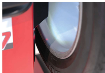
Лазерный указатель для точного обозначения места установки грузов на клеящейся основе
